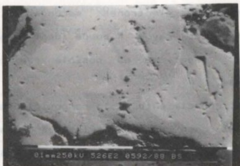
Fig Nº 11 - Imagen de electrones retrodifundidos de partículas de Galena y Argentita.
