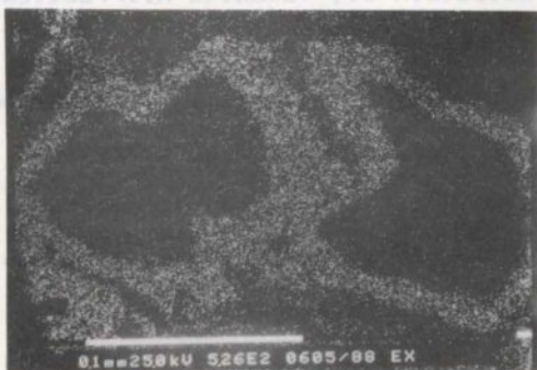
Fig Nº 12 - Distribución de Plata en la partícula de la figura anterior.
